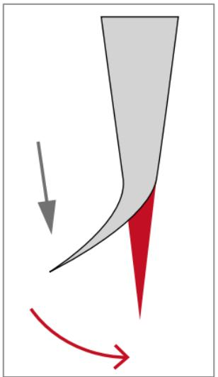
Eine umgelegte Schneide richtet man durch Abziehen auf dem Abziehblock wieder auf. Dabei das Werkzeug mit der Schneide im üblichen Winkel etwa 5- bis 10-mal auf jeder Seite der Klinge mit mittlerem Druck über die glatte Seite der Abziehbank ziehen. Schrittweise die Anzahl der Züge auf einer Seite und den Druck reduzieren, so dass am Ende wechselseitig mit leichtem Druck abgezogen wird.
